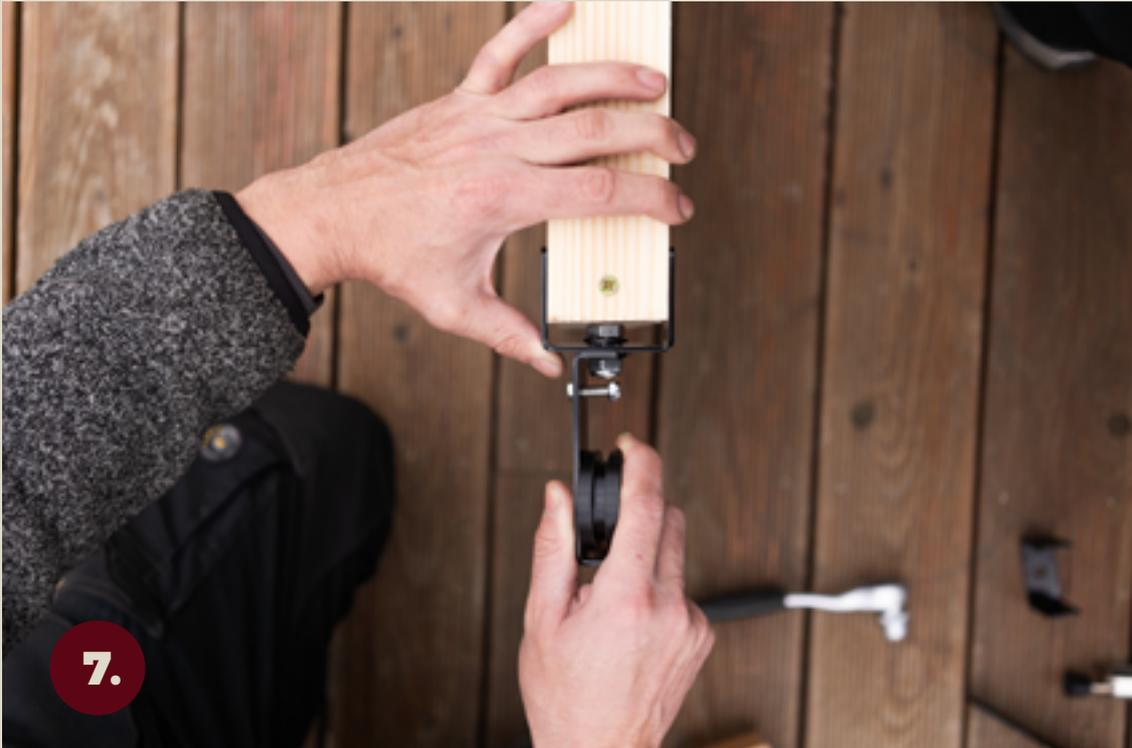
Bereiten Sie den Mechanismus mit der Rolle vor und befestigen Sie ihn mit Schrauben am Rand des Sonnenbrechers (bei Verwendung von Sonnenbrechern mit einer Breite von 50 cm und dem Falten in eine sogenannte Ziehharmonika, befestigen Sie ihn in der Mitte des Sonnenbrechers).
