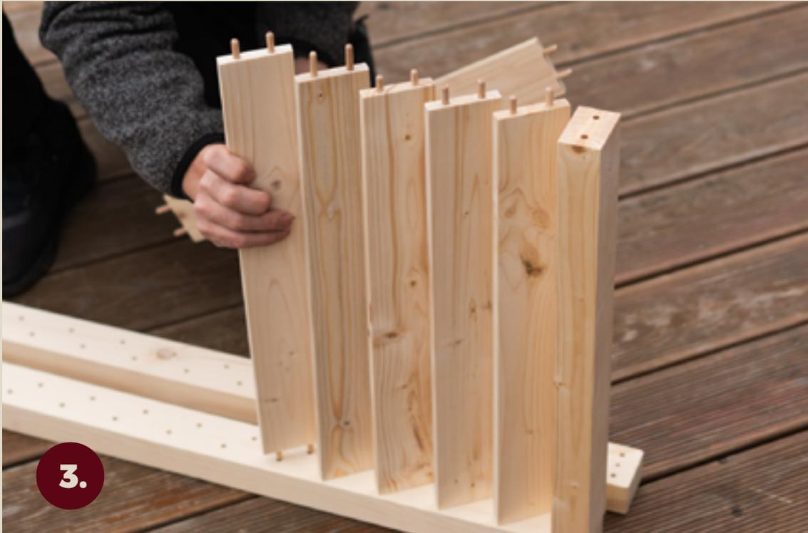
**3.** Stecken Sie die Lamellen mit eingesteckten Stiften in eine der Seitenwände. Setzen Sie das obere und untere Querstück auf.
